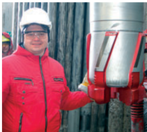
«Буровой башмак» с резами PDC фирмы Weatherford для бурения на обсадной колонне.
