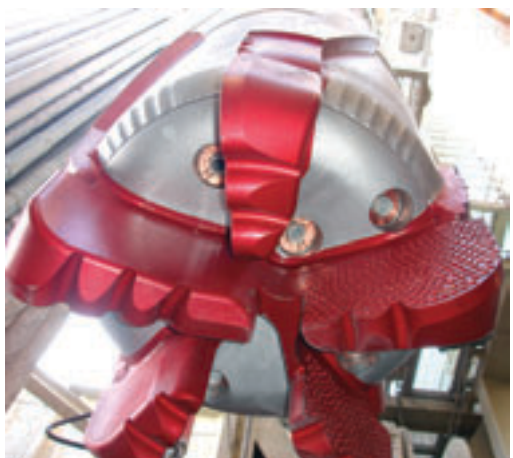
«Буровой башмак» с резами PDC фирмы Weatherford для бурения на обсадной колонне.
